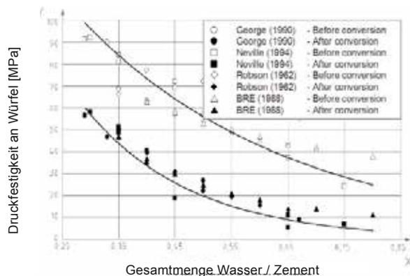
Für Anwendungen im Baufach wird die Verwendung von mindestens 400 kg/m<sup>3</sup> Ciment Fondu® mit einem Wasser-Zement-Verhältnis < 0,40 empfohlen.
