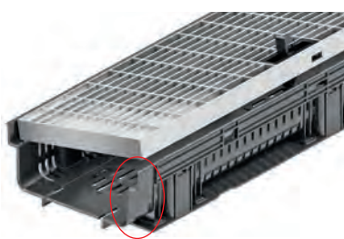
ACHTUNG! Vor Verlegen des ersten Rinnenelements die Rinne am Rinnenanfang um 1 cm kürzen – siehe Schnittführung
