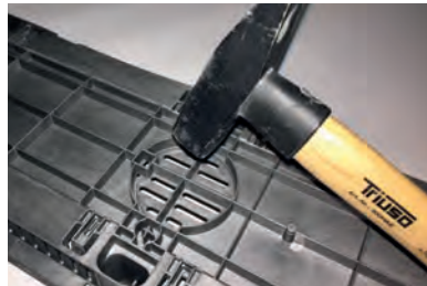
Ausschlagen der Bereichs für den Einsteckstutzen
