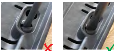
Jetzt wird die Profiline X auf die Verstelleinheit gestellt und von oben eingedrückt bis die Verstelleinheit hörbar einrastet. Nun ist die Höhenverstellung voll funktionsfähig.
