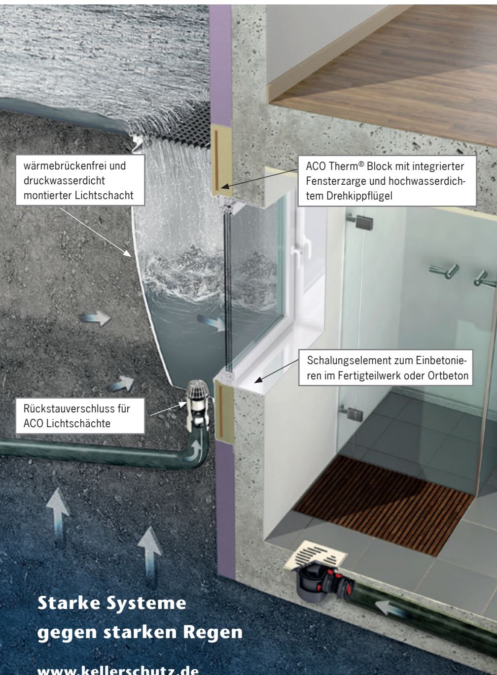
■ ACO Therm® Block DWD mit integriertem ACO Therm® Fenster Standardausführung
