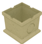
Aufsatzkasten aus Polymerbeton zur Aufstockung der Bauhöhe, mit Vorformung DN/OD 110 für Fallrohranschluss
