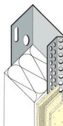
Aluminiumtrogrprofil I ohne Tropfkante für vertikale Abschlüsse von WDVS z.B. bei Reihenhäusern
