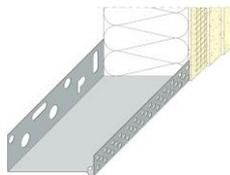
Aluminiumtrogrprofil mit Tropfkante
