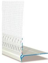
Wärmebrückenreduziertes PVC- Sockelprofil, wird bei schon vorhandener Sockeldämmung zwischen Fassaden- und Sockeldämmung gesteckt. Erfolgt die Sockeldämmung später werden zusätzlich die HECK Montagewinkel lot- und fluchtgerecht auf die Fassade geklebt bzw. gedübelt
