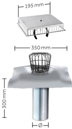
Erhältlich mit einem Wolfin oder einem universellen, grauen Bahnenflansch. Materialstärke 0,7 mm, Rohrlänge 300 mm für Dämmstoffdicken von 115 bis 230 mm, passend für Grundelement oder Rohr mit Muffe. Kombinierbar mit Kiesfang SD für höhere Ablaufleistungen. Systemteile können in Titangrau oder mit original grauem Wolfin Bahnenflansch als Sonderanfertigung bestellt werden.
