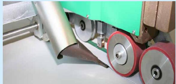
Lange Bahnnähte werden mit dem Schweißautomaten besonders gleichmäßig, sicher und rationell verschlossen.
