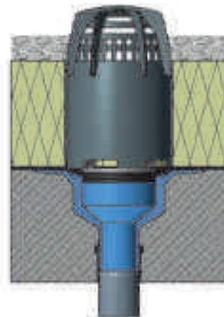
Höhenangepasster Umkehrdachaufsatz inkl. Kiesfangkorb im Umkehrdach mit Kiesschicht.
