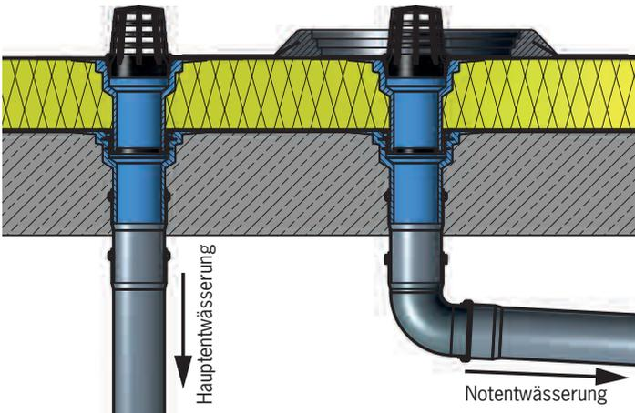
Dachgullys mit Aufstockelement im Warmdach, einmal als Hauptentwässerung und einmal mit Anstaurung als Notentwässerung (rechts).
