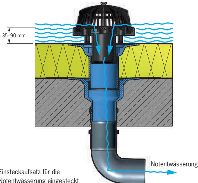
Einsteckaufsatz für die Notentwässerung eingesteckt in Kompakt-Kragen-Gully mit Aufstockelement im Warmdach.
