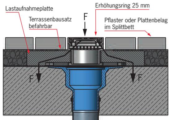
Kompakt-Kragen-Gully mit Lastaufnahmeplatte und Terrassenbausatz befahrbar mit Plattenbelag im Splittbett verlegt. Die Lastaufnahmeplatte leitet die auf den Terrassenbausatz einwirkende Kraft am Ablauf vorbei in die Betonplatte.
