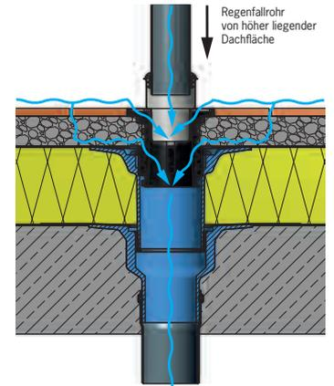
Kompakt-Kragen-Gully mit Aufstockelement und Terrassenbausatz mit Siebringaufsatz in Terrasse eingebaut
