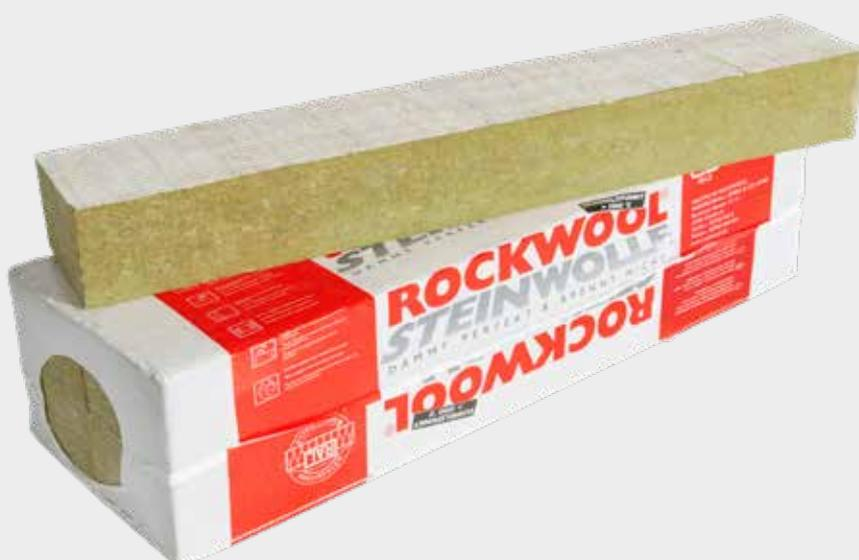
Nichtbrennbare einseitig beschichtete Steinwolle-Putzträgerplatte für den Einsatz als gebäudeumlaufender Brandriegel oder als Brandbarriere in schwerentflammaren Wärmedämm-Verbundsystemen.
