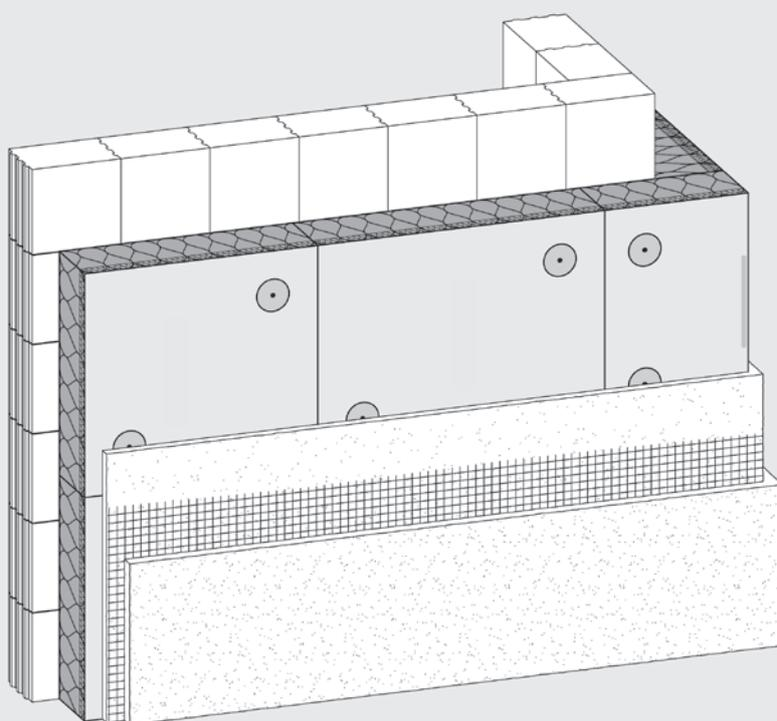
Nichtbrennbare Steinwolle-Platzträgerplatte als Kernstück für Wärmedämm-Verbundsysteme. Durch eine hoch verdichtete Oberlage werden eine hervorragende Putzhaftung und einfachere Verdübelung gewährleistet. Die Beschichtung auf den Plattenoberflächen ermöglichen die maschinelle Verarbeitung des Klebemörtels auf dem Untergrund sowie den Putzauftrag ohne Pressspachtelung.
