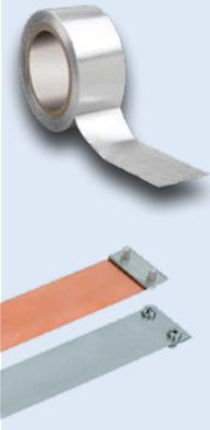
Das Climafit Tape ist ein Erdungsklebeband, welches zur Ableitung niederfrequenter elektrischer Felder bei einlagigen Beplankungen mit Climafit-Platten auf Holzunterkonstruktionen zwingend notwendig ist.
