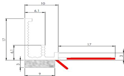
Selbstklebendes Laibungsanschlussprofil zum Herstellen der Putzanschlüsse im Innen- und Außenbereich bei Massivmauerwerk für alle gängigen Nassputzsysteme. Ausgestattet mit weißem, schlagregendichten PE-Schaumband, TPE-Schutzlippe, gelochtem Einputzschenkel, doppelter Abzugskante und flexiblem Abziehstreifen zur Aufnahme von Schutzfolien.
