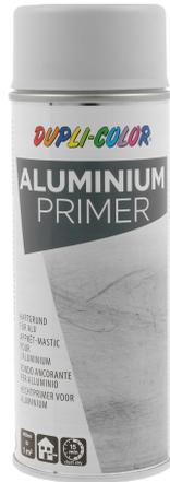
Spezialgrundierung für Aluminiumflächen auf spezieller Acrylharz-Basis. Hervorragender Haftvermittler zwischen Aluminiumuntergrund und nachfolgendem Decklack. Bedingt auch für Zink und Kupfer geeignet, wenn eine anschließende Lackierung gewünscht wird. Kann mit allen lufttrocknenden Acryl-, NC- und Kunstharzlacken überlackiert werden, z.B. mit DUPLI-COLOR Auto-Spray oder DUPLI-COLOR ALL SEASON.
