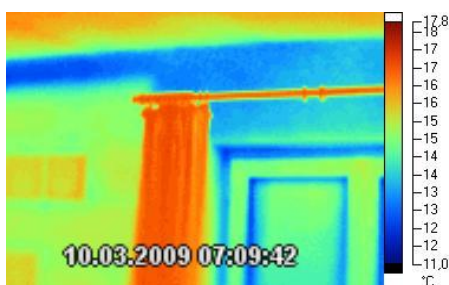
Wärmebrücke Betonsturz über Fenster
