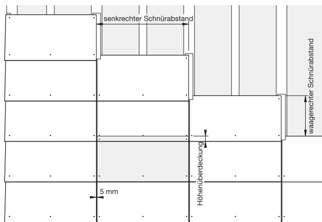
Beispiel: Format 60 x 30 cm, mit auslaufender Ortdeckung
