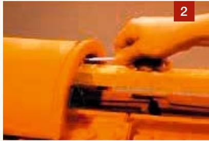
Sicherungsstab bis zum Anschlag in Bohrung einführen und leicht nach oben ziehen.
