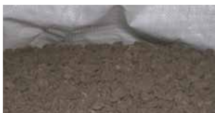
MOGAT Substratschicht Lose Schüttung aus Lava/Bims-Mischung Schütthöhe: 60 bis 80 mm Lieferung als 25 l-Sackware (benötigt werden ca. 75 l/m 2 ); im Big Bag (1000 kg/ca.10 m 2 ) oder Silo
