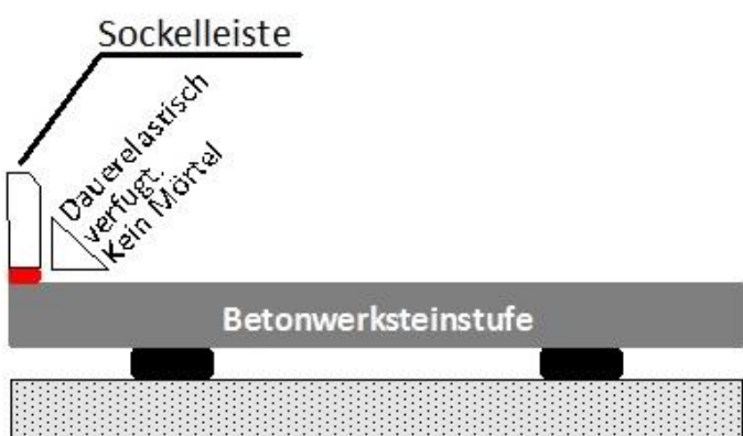
Sockelleisten nicht direkt auf Betonwerksteinstufen setzen!
